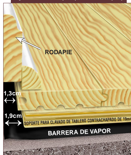
Figura 5: Detalle del Soporte (tablero contrachapado)
