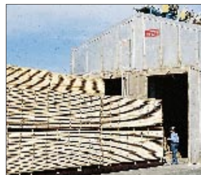
El secado y acondicionamiento en cámara del Pino Amarillo reduce las fendas superficiales, las fendas normales y las deformaciones.
