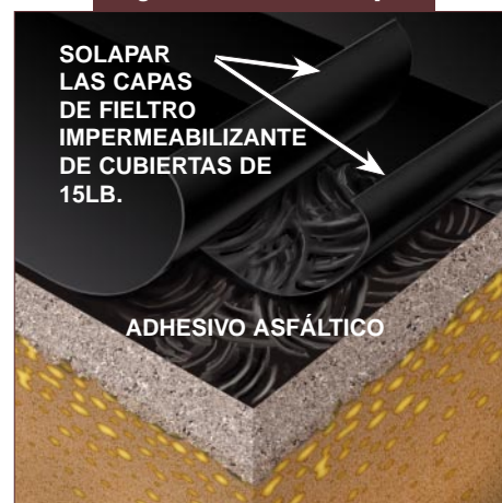
Figura 3: Barrera de Vapor
