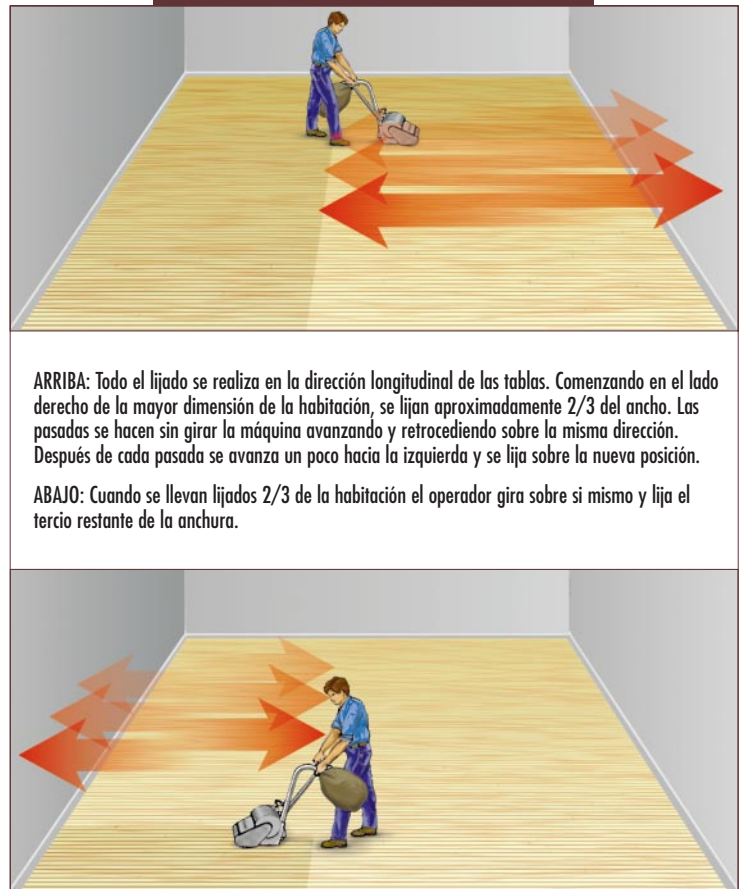
Figura 12: Lijado del Pavimento
